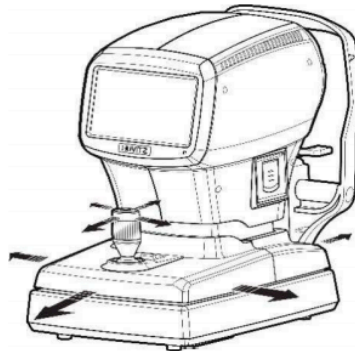
[Operando o joystick para ajustar esquerda/direita e também o foco]
