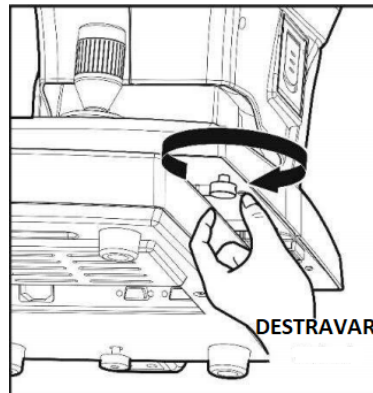
[Estágios de destravamento: 2 (Travas do corpo do equipamento)]
