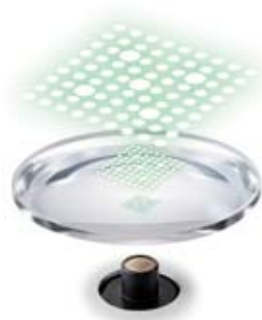
Sensor de Hartmann / Feixe de Luz Verde (540nm)
